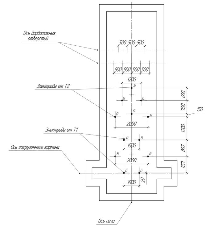
Расстояние кабельной трассы для силового кабеля от комплектного силового шкафа до каждого электрода Е1 - 20м.
